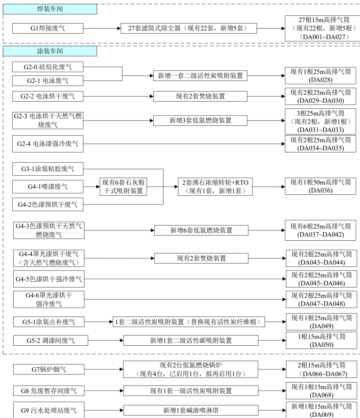
图 4.7-1 本项目废气处理及排放示意图
